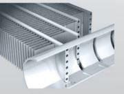
A linha de resfriadores 30XA possui como opcional os condensadores do tipo microchannel. A tecnologia Novation® de trocadores de calor da Carrier inclui serpentinas com microcanais de altíssima eficiência. Os condensadores microchannel são até 60% mais leves que trocadores convencionais, além de requerer uma menor carga de refrigerante e contarem com maior facilidade de manutenção e limpeza.
