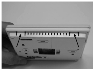
Fig. 3 – Pressione as abas para remover a placa traseira
