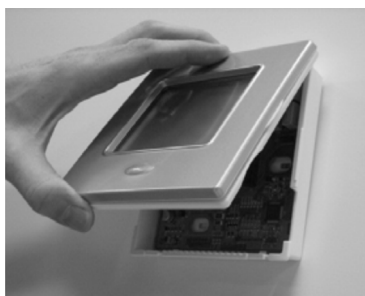
Fig. 14 – Reanexe o módulo do visor
