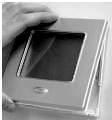
Fig. 9 – Anexe o visor à tampa protetora traseira
