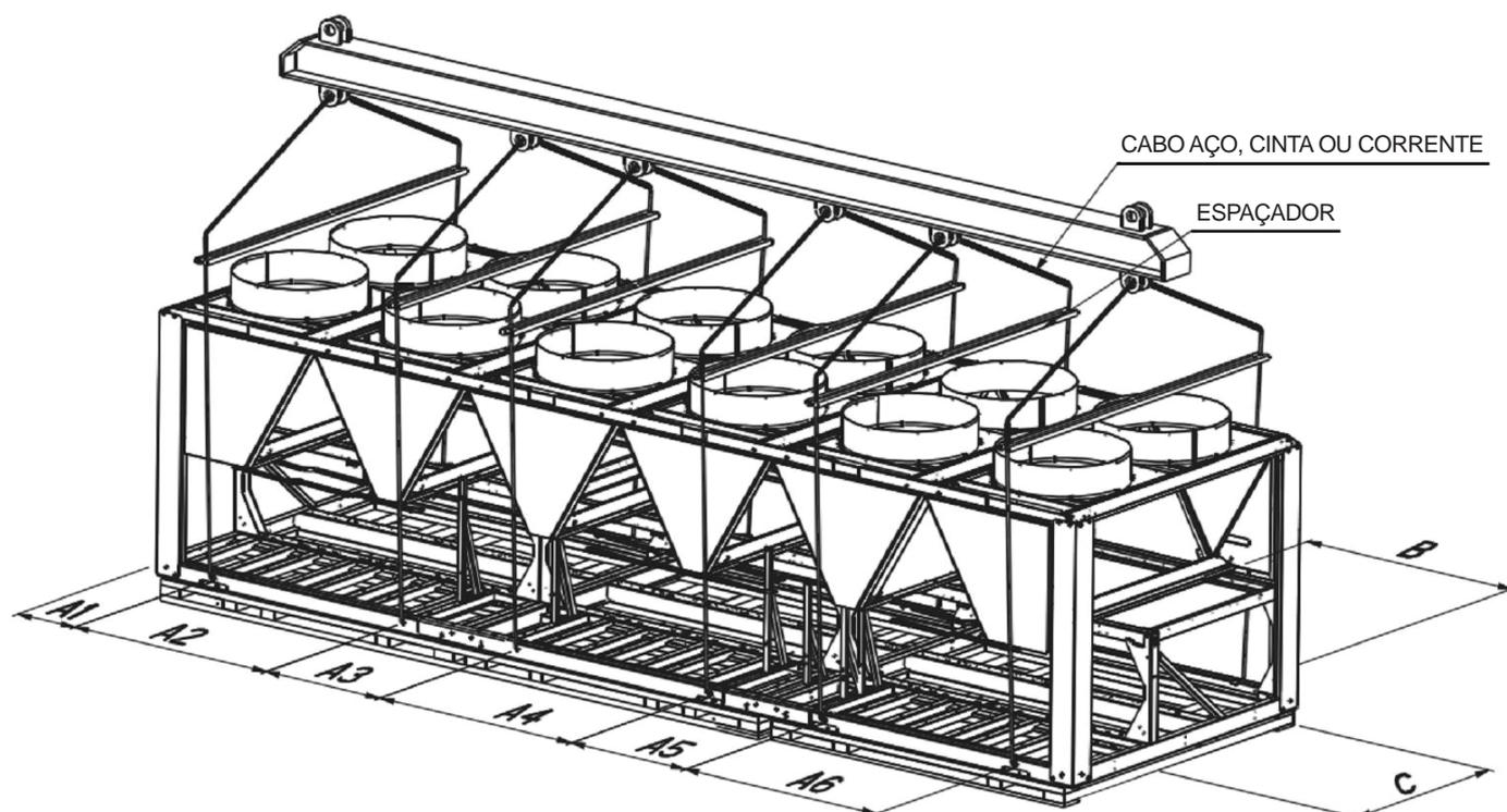
**A UNIDADE DEVE SER IÇADA POR TODOS OS PONTOS DE IÇAMENTO EXISTENTES NO CHASSI**
